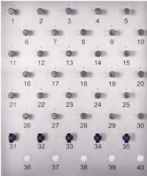
Fentes pour clés avec fiches de sécurité verrouillées, fiches d'identification bleues non verrouillées
